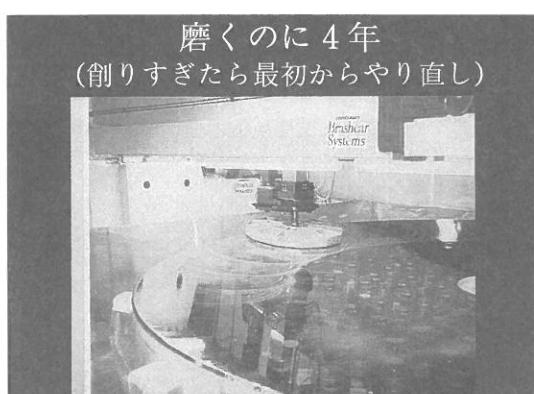
図5 すばる主鏡の研磨のようす
